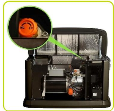
EL conducto de gas debe ser calculado para plena carga. La presión del combustible a la entrada para todo el rango estará entre 0.87-1.74 (3.5"-7" de columna de agua) para gas natural, 2.49-2.99 kPA (10"-12" de columna de agua) para GLP. Los datos de salida están basados en valores de 37,26 Megajulios por metro cúbico con gas natural y 93,15 Megajulios por metro cúbico en GLP.
